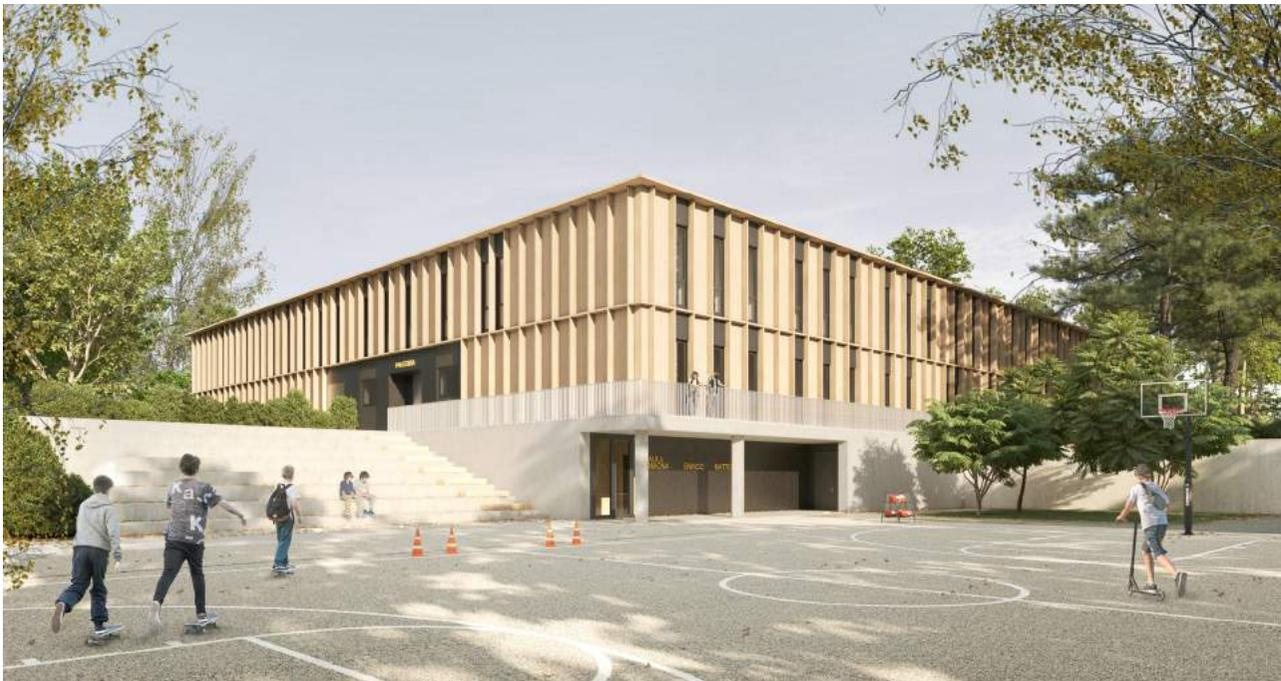
La facciata è ritmata da lame verticali che aiutano a schermare la luce solare e donano leggerezza all'intero volume, mentre l'attacco a terra è costituito da un basamento in cemento che contiene l'auditorium al piano seminterrato e definisce gli ingressi al piano terra.
