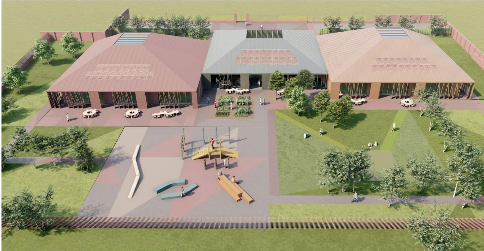
I tre volumi a pianta quadrata ad un piano fuori terra definiscono un unico organismo la cui compattezza volumetrica ha permesso di eliminare spazi scarsamente funzionali e diminuire le dispersioni termiche delle superfici perimetrali. L'aspetto semplice e giocoso viene ulteriormente evidenzia-
